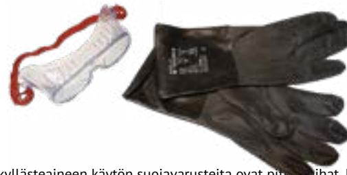
Taljan kyllästeaineen käytön suojaruusteita ovat pitkäsihahat, EN 166:n mukaiset sivusuojilla varustetut suojalasit sekä EN 374:n mukaiset butyylikumiset kemikaalisuojakäsineet.
